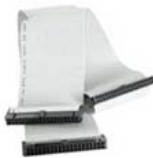
Figura 1.20: Un flat cable .
