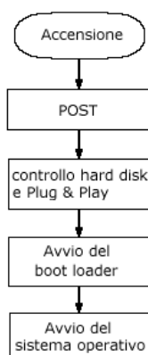
Figura 2.1: Schema del boot del sistema.
