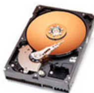
Figura 1.22: Interno di un hard disk.
